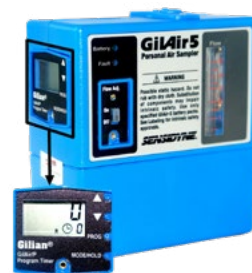
Foto 2 | Detailfoto van de luchtpomp die de voeding levert om lucht in de ademzone aan te zuigen. Deze wordt bevestigd aan uw riem.
