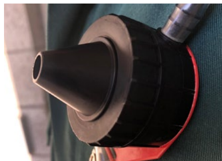
Foto 3 | Een foto van de monsternamekop waarmee lucht in de ademzone wordt aangezogen. Deze wordt bevestigd aan uw borstzak.
